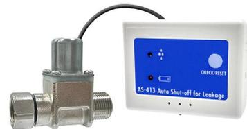
Achtung: überprüfen Sie in regelmäßigen Abständen die Funktion des Magnetventiles, dies kann durch Schmutz etc. festsetzen. Legen Sie dazu die Kontakte in Wasser, dann muss das Ventil schliessen, tut es das nicht, dann reinigen Sie das Ventil und beheben die Ursache.
